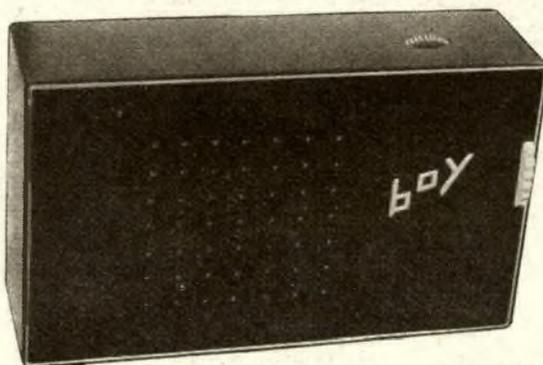
**Bild 1:** Vorderansicht des Gerätes. Der weiße Knopf an der rechten Schmalseite ist die Abstimmung, während die Lautstärke mit dem auf der Oberseite sichtbaren Knopfpotentiometer geregelt wird. Durch in die Frontseite nach einem Muster gebohrte Löcher (2 mm Ø) wird der Schall abgestrahlt
