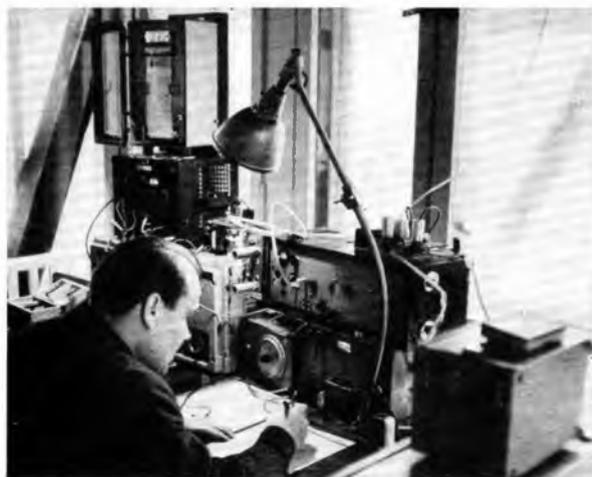
Bild 2: Umfangreich war die im Turm aufgebaute Empfangsanlage, die aus Geräten für verschiedene Bandbreiten bestand. Die Meßwerte wurden fortlaufend registriert. Außerdem wurde gewissenhaft Protokoll geführt
