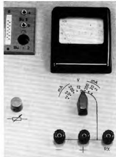
Bild 1: Meßteil des „transpoly“ für Strom-, Spannungs- und Widerstandsmessung. Das Meßteil kann auch getrennt vom Experimentier-Teil benutzt werden
