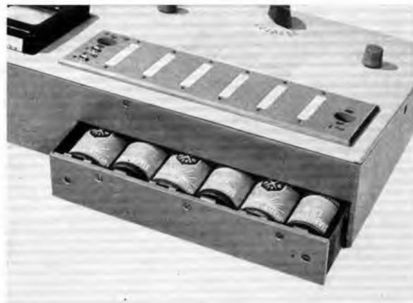
Bild 5: An der Rückseite des Elektronik-Experimentier-Baukastens „transpoly“ befindet sich ein Einschub mit der Stromversorgung aus sechs Monozellen. Mit dem Spannungswahlschalter können die Betriebsspannungen 1,5 – 3 – 4,5 – 6 – 7,5 – 9 V eingestellt werden
