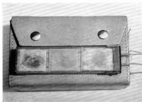
Bild 7: Batterie aus zwei Trockenakkus als Ersatz für Flachbatterien
