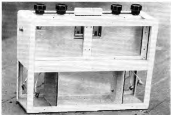
Bild 19: Rückansicht des mechanischen Aufbaus der Kleinstation. Auf dem inneren Rahmen werden die Baueinplatten befestigt
