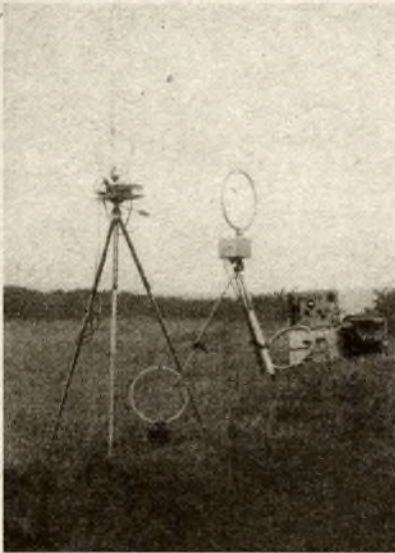
Bild 15: Anordnung von Testempfänger (links) und Feldstärkemeßgerät (rechts) im Gelände für die beschriebene Empfindlichkeitsmessung
