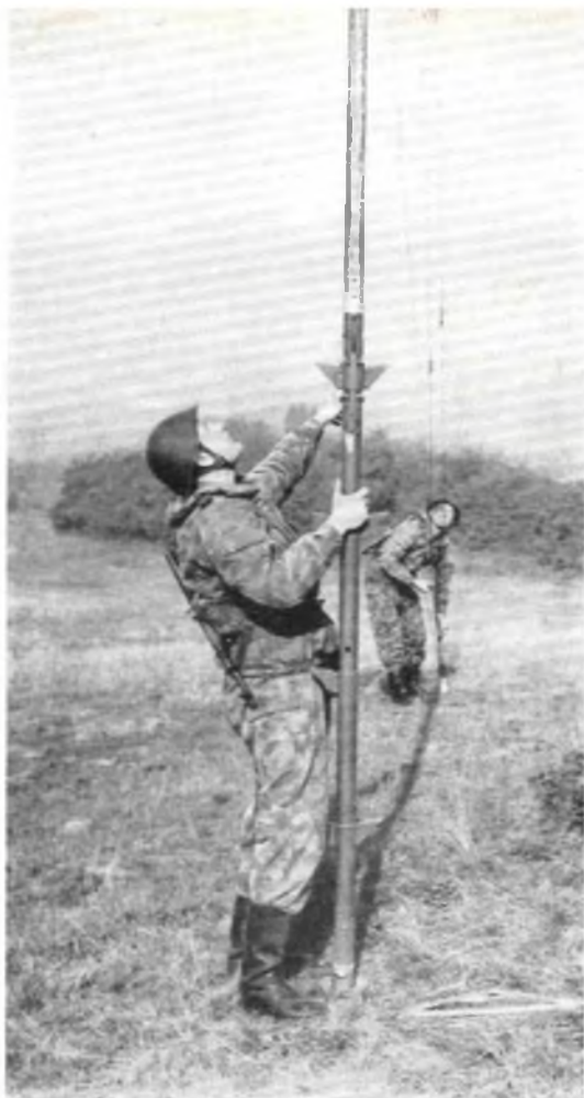
Soldaten eines Richtfunktrupps beim Aufbau ihrer Station. Als Stellung wählten sie einen offenen Platz auf einer Anhöhe, um eine große Reichweite zu erzielen und einen möglichst störungsfreien Betrieb zu gewährleisten
