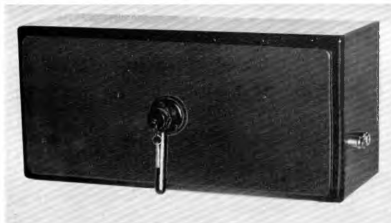
Bild 4: Ansicht des Empfängers (links unten). 16 Informationskanäle stehen im Bereich 70 bis 87,5 MHz zur Verfügung
