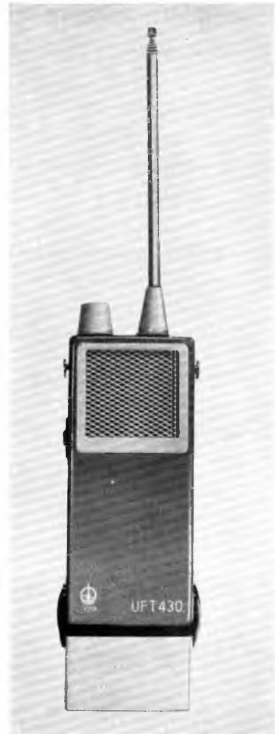
Bild 4: Ansicht des Empfängers (links unten). 16 Informationskanäle stehen im Bereich 70 bis 87,5 MHz zur Verfügung
