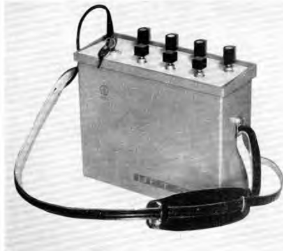
Bild 2: Das Handfunk- sprechgerät UFT 430 ar- beitet mit einer Sendeleistung von 20 mW auf einem Kanal im Bereich von 27,27 bis 27,97 MHz. Die Empfängerempfindlichkeit ist besser als 3 \mu\text{V} (rechts)
