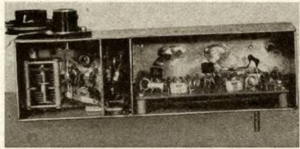
Bild 8: Blick in das geöffnete Chassis des VHF-Meßteiles
