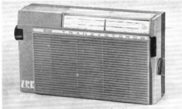
Bild 1: Mit 8 Transistoren und 2 Diaden polnischer Fertigung bestückt ist der Empfänger „Gulliver“. Die Ausgangsleistung ist 200 mW, Empfangsbereiche sind Lang- und Mittelwelle, die Stromversorgung besteht aus zwei Flachbatterien
