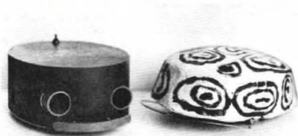
Bild 5: Die Station Junger Techniker und Naturforscher Lauchhammer-Ost stütete ihr Modell „Kybi 1“ mit einem kombinierten Hör- und Tastsinn aus (links). Sehr sauber und mit gedruckter Verdrahtung ausgestattet ist das kybernetische Modell von K.-J. Butz, Hennigsdorf, das auch erweitert wurde
