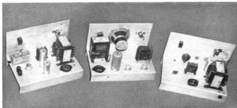
Bild 7: Das sind Geräte, die von Kursteilnehmern in Karlovy Vary aufgebaut wurden. Links im Bild ein Oszillator zur Prüfung von Quarzen. In der Bildmitte ein Morse-Tongenerator. Ganz rechts ein Multivibrator für Prüfungszwecke. Alle Geräte besitzen eine eigene Stromversorgung und werden für die weitere Ausbildung benutzt
