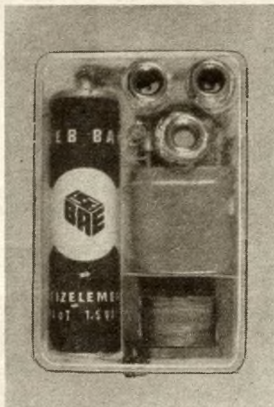
Bild 3: Ansicht des Versuchsmusters. Größe 55 × 35 × 15 mm, links die Monozelle, obere Steckbuchsen: Pol 2-3 (Bild 2), untere Buchse: Pol 1. Rechts Mitte der Quarz, rechts unten Überträger K 21. Zwischen unterer Buchse und Batterie ist als punktförmiges Bauteil die Tunnelodiode erkennbar
