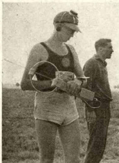
Bild 1: Zu dem leistungsfähigen Peilempfänger gehört bei Gretschichin der Radiokompaß, den er auf dem Kopf trägt. Vorteilhaft ist auch der Kartenhalter am Arm
