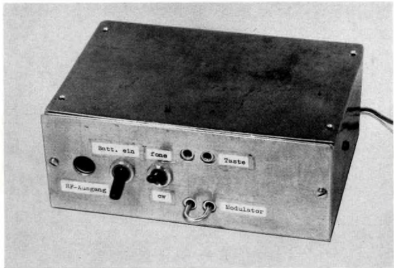
Bild 1: Der Senderbaustein wurde in diesem kleinen Gehäuse untergebracht. Der Kurzschlußbügel wird bei Fone-Betrieb entfernt und dafür der Ausgang des Modulatorbausteines angeschlossen (oben)
