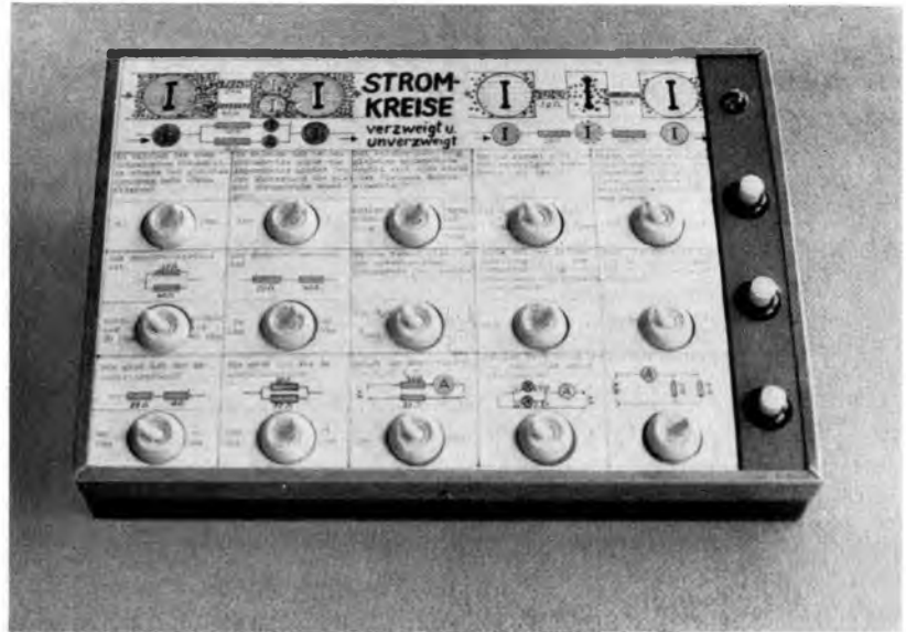
Bild 1: Gesamtansicht der kleinen Lernmaschine mit dem Programm „Verzweigte und unverzweigte Stromkreise“. Rechts die Knopfkontakte und das Kontrollämpchen (oben)
