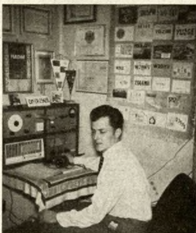
Links oben 0-V-1, darunter BC-RX Rostock 493, Rechts oben Netzteil, darunter Converter.
