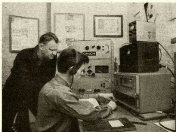
DM 4 ZCM an der Station, daneben DM-1954 M. TX: 8stufig mit Bandfiltern, PA: SRS 551 – 150 Watt Input max. RX: Dabendorf (ungespreizt) Mod.-Verstärker: MV 23
