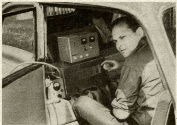
Unsere Polni den-Station: oben links Sender 15 W input (2 × EL 88); darunter Empfänger (10-Röhren-Doppelsuper, Kaskode, 2 × EC 86). Modulator und Netzteil in einem Gehäuse Fotos: DM 2 CRL
