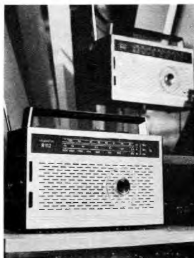
Bild 5: Einen UKW-Bereich sowie MW und KW besitzt der RFT-Reisesuper R 112 TRANSISTOR. 10 FM / 7 AM-Kreise, 9 Transistoren und 4 Dioden (VEB Stern-Radio Berlin)
