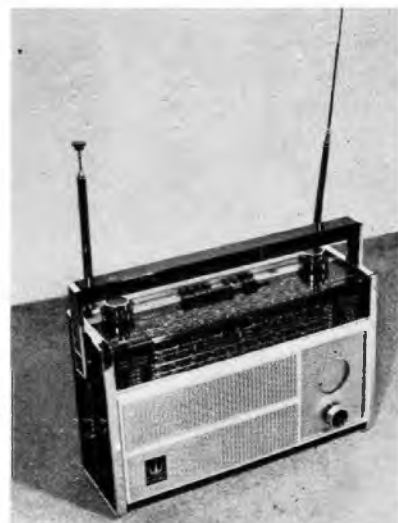
Bild 6: Das Spitzengerät der französischen Firma PYGMY ist der Super 2001, der mit 16 Transistoren und 5 Dioden bestückt ist (Wellenbereiche UKW, LW, MW, 7 × KW)
