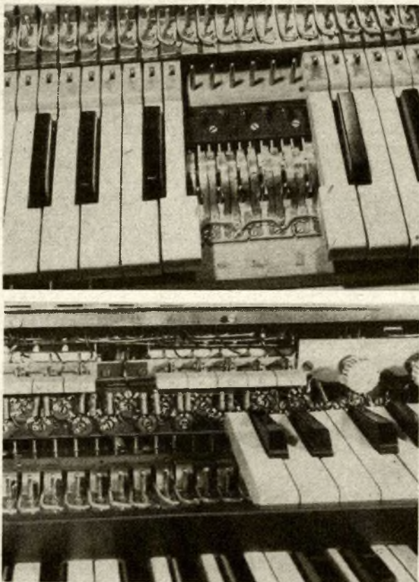
Bild 46: Tasten und Kontakte des Obermanuals mit dahinterliegender Widerstandskette und Anordnung der Registerschalter
