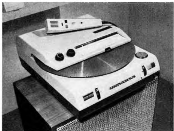
Bild 3: Für die Assmann-Diktiergeräte entwickelte die westdeutsche Firma Sennheiser electronic ein Mikrophon mit elektronischem Schalter, der die Einschaltgeräusche vermeidet
