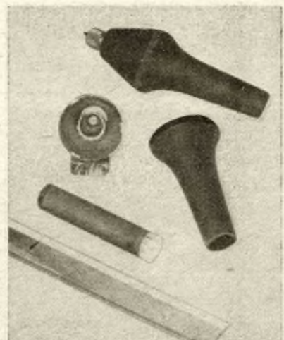
Bild 2: Einzelteile des Abschlußwiderstandes von Bild 1
