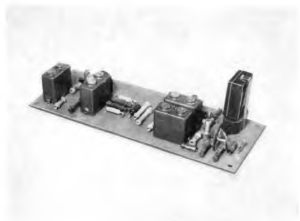
Bild 5: Zur Umsetzung eines SSB-Signals dient diese Mischstufe mit Dioden von Kam. O. Hentschel, DM 2 CFO. Die Trägerunterdrückung ist besser als 60 dB. Verwendet wird eine gedruckte Schaltung
