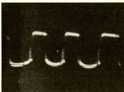
Bild 8: Oszillogramme am Eingang des Kommandoauswerters (aufgenommen vom „Oszi 40“) Bild 8 a (oben) Oszillografenkippfrequenz etwa 6 kHz, Pendelfrequenz etwa 70 kHz, kein HF-Eingangssignal vorhanden, Bild 8 b (unten) Kippfrequenz etwa 6 kHz, HF-Spannung mit Träger-Ton-Modulation am Pendler vorhanden. Begrenzerstufe auf etwa 450 mV eingestellt
