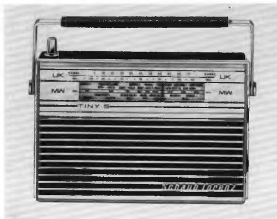
Zu SEL gehört auch die Schaub-Lorenz-Vertriebs-GmbH, die u. a. den Transistor-Taschenempfänger „Tiny S“ zeigte, der mit 9 Transistoren und 6 Dioden bestückt ist
