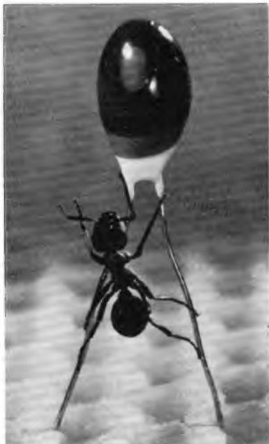
Tantal-Kondensatoren mit festem Elektrolyten haben infolge der hohen spezifischen Kapazität nur sehr geringe Abmessungen
