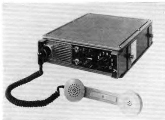
Das UKW-Funksprechgerät SEM 47-1620 G arbeitet mit 10 Kanälen im 2-m-Band. Das Gerät ist für den Gegensprechverkehr ausgelegt
