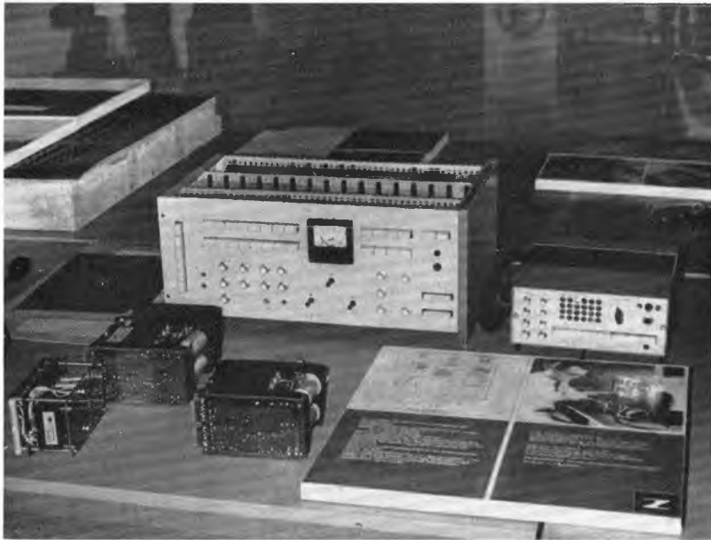
Bild 1: Normteile für den wissenschaftlichen Gerätebau erlauben es, die Entwicklungszeit wesentlich zu verkürzen. Ing. J. Stephan und Ing. W. Gläser vom Zentralinstitut für Kernforschung Rossendorf entwickelten diese Bausteinserie
