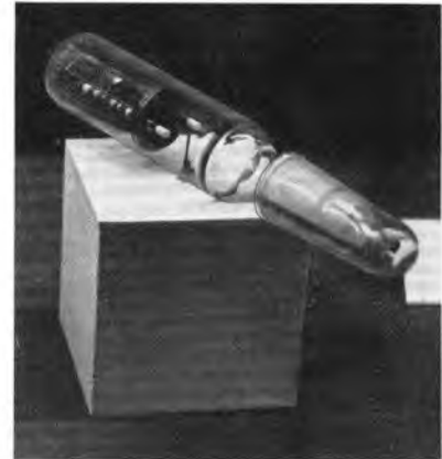
Bild 3: Mit der Entwicklung eines Gerätes zur Schnellbestimmung der Gaszusammensetzung in Hoch- und Höchstvakuumssystemen befaßte sich H. Stötzel (DM 2 ARL) in seiner Dissertation am Institut für Allgemeine Elektrotechnik (TU Dresden). Die Ergebnisse der Arbeit werden vom VEB Hochvakuum Dresden zur Verbesserung der Meßbröhre im Restgasindikator „Inditron“ angewandt. Fotos: MBD, Heintz
