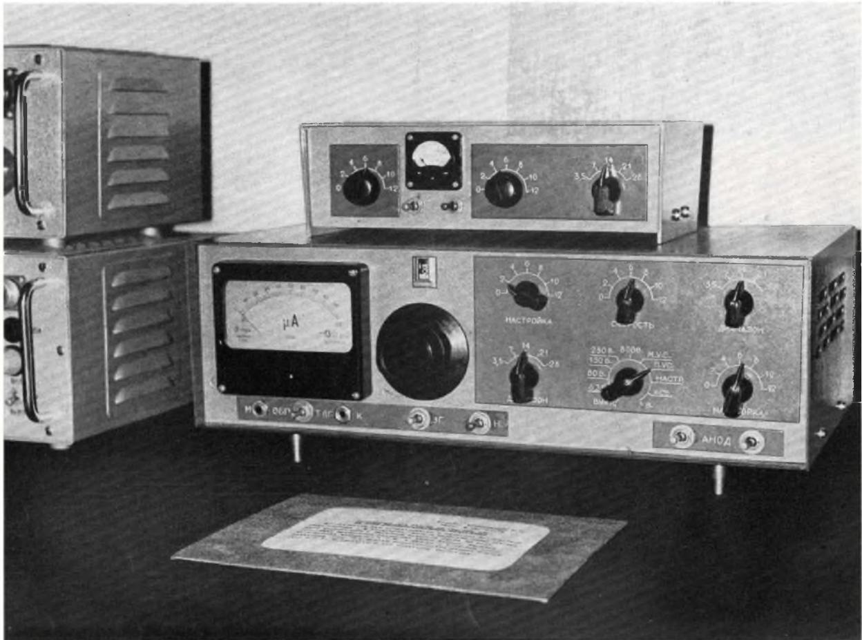
Die Geräte der Funkamateure bilden nur eine Abteilung innerhalb der Allunionsausstellung der Radioamateurkonstrukteure der DOSAAF, aber alle Frequenzbereiche von 3,5 bis 1296 MHz waren mit Geräten vertreten. Unser Foto zeigt die in moderner Flachbauweise gehaltene SSB-Station von U 3 WRW, oben ein 30-Watt-Sender, unten ein 90-Watt-Sender für alle KW-Bereiche.
