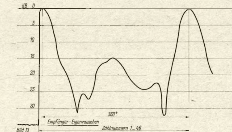
Bild 13: Horizontal-Richtdiagramm einer 5-Element-Langyagiantenne mit Reflektor, Aufnahme mit einem log. Dämpfungsschreiber an der Station DM 2 BUO
