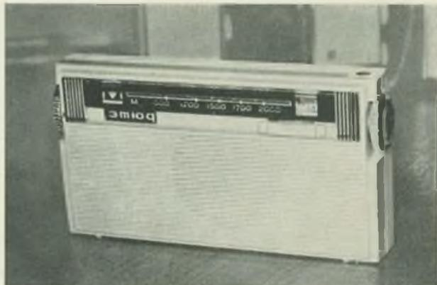
Bild 4: Als „tönendes Notizbuch“ bezeichnet wird der mit einem Notizblock kombinierte Transistorsuper „Sjurpris“ (Überraschung), MW, 6 Transistoren, 5 Kreise, 135 mm × 85 mm × 15 mm
