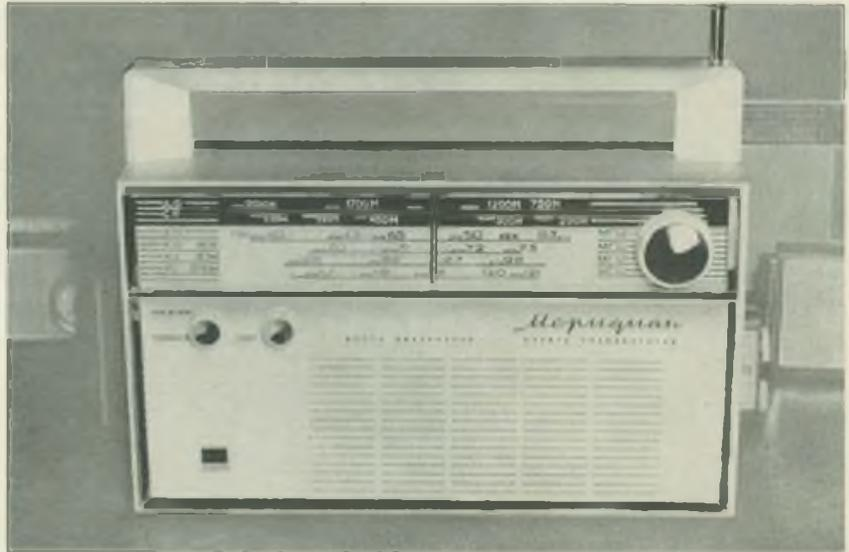
Bild 2: Der Transistorsuper „Sokol-4“ hat 4 Wellenbereiche (2 × KW, MW, LW) und ist mit 8 Transistoren bestückt. Für den KW-Empfang (4...7,3 MHz und 9,5...12,1 MHz) ist eine getrennte Feinabstimmung vorhanden, der ZF-Verstärker enthält ein piezoelektrisches Filter. Die Ausgangsleistung ist etwa 100 mW, zur Klangregelung ist ein Umschalter für Höhen und Tiefen vorgesehen
