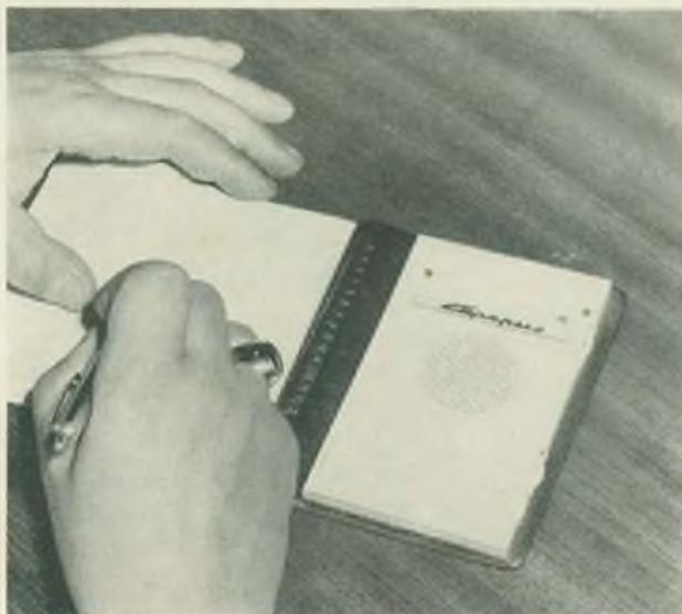
Bild 5: Der kleinste Transistorempfänger ist der „Mikro“, dessen Schaltung in Dickfilmtchnik ausgelüht ist. MW und LW, 43 mm × 30 mm × 7,5 mm, 27 g. Der Empfänger arbeitet in Geradeausschaltung mit 4 HF- und 2 NF-Stufen. Fotos: MBD, Hein
