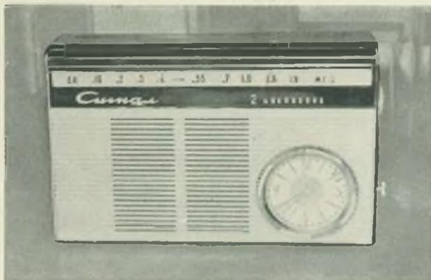
Bild 3: Sehr flach konstruiert ist der Transistorempfänger „Etjud“ (Etüde), 141 mm × 80 mm × 24,5 mm. Das für MW und LW ausgelegte Gerät ist mit 7 Transistoren und 3 Dioden bestückt.
