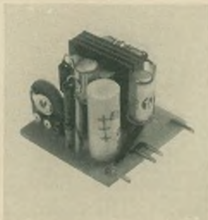
Bild 4: Der fertige Baustein (Größe 25 mm × 25 mm)
