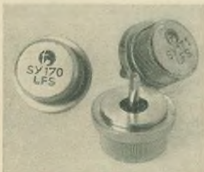
Bild 1: Für den Einsatz im Kraftfahrzeug wurden vom VEB Halbleiterwerk Frankfurt O. die Gleichrichterdioden SY 170...SY 173 entwickelt
