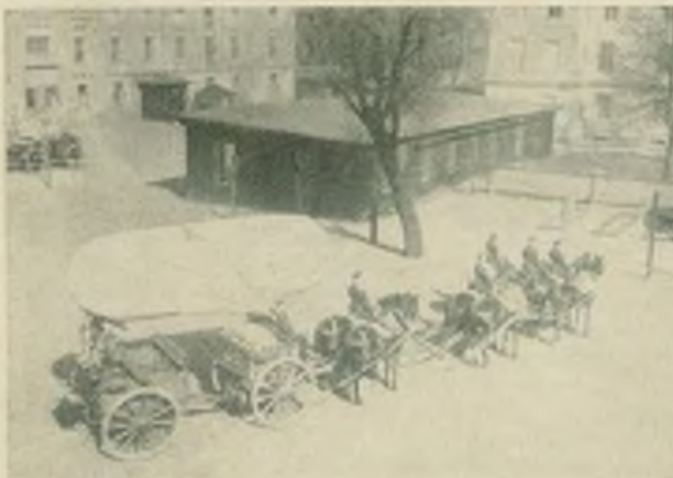
Unten: Ein britischer Offizier am tragbaren Marconi-Peilempfänger. Links: Fahrbare deutsche Funkstation um 1905. Der Ballon über dem Gespann diente zum Auflassen der Antenne
