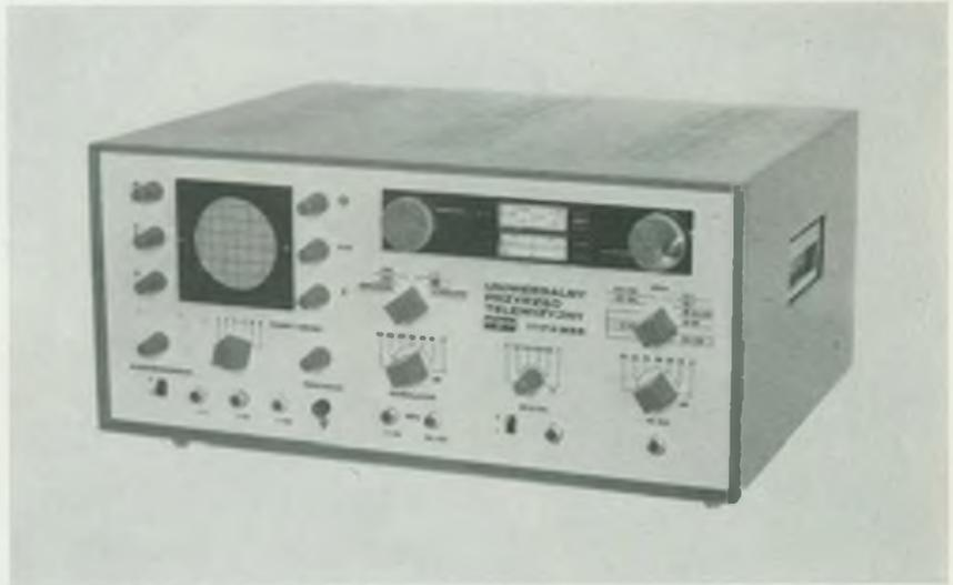
Bild 7: Zur direkten Frequenzmessung im Bereich von 30 Hz bis 1 MHz in 10 Meßbereichen dient der Frequenzmesser „MC-3“ der Firma „Radiotechnika“. Die maximale Eingangsspannung ist 200 V, der Eingangswiderstand ist 0,5 MOhm. Die Fehlergrenze bei Vollausschlag ist besser als 3 %
