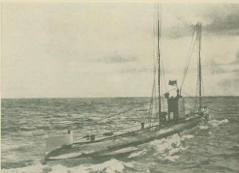
aufrichtbare Funkantennen, die später gegen niedrigere Empfangseinrichtungen ausgewechselt wurden.
