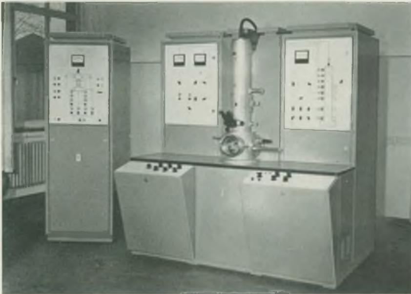
**Bild 6:** Die Elektronenstrahl-Bearbeitungsanlage EBS 80 200 wurde in Zusammenarbeit zwischen dem Forschungsinstitut Manfred von Ardenne und dem VEB Elektromat entwickelt. Der Anwendungsbereich erstreckt sich von der Mikrobearbeitung dünner Schichten, Folien und massiver Körper aus organischen und anorganischen Materialien bis zum Feinschweißen
