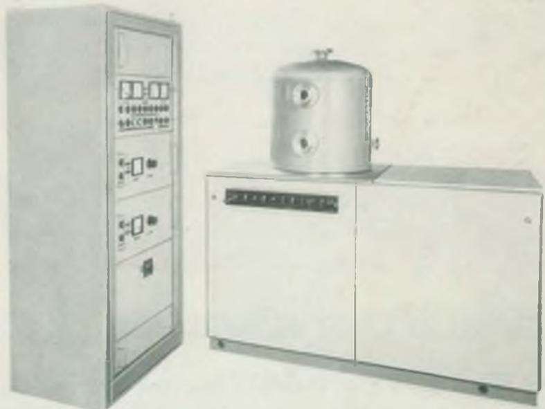
**Bild 7:** Hochvakuum-Bedampfungsanlagen dienen zum Herstellen dünner Schichten unter Hochvakuum. Es können Schichten unterschiedlicher Zusammensetzung und Dicke, beginnend bei wenigen Atomlagen, aufgebracht werden. Bei der Hochvakuum-Bedampfungsanlage E 55 des VEB Hochvakuum Dresden handelt es sich um eine universelle Anlage für Forschungslabors oder auch Fertigungsprozesse
