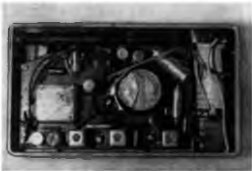
Bild 3: Ansicht des auf 100 Ohm ausgelegten Matchinggeräts
