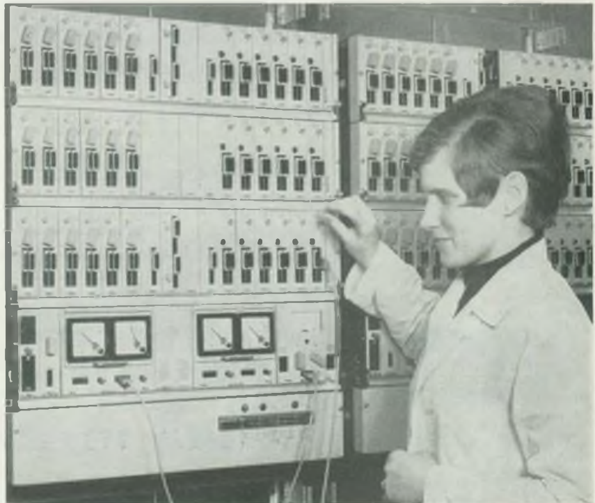
Bild 3: Der neue Allverstärker TAV 70 K in Kofferausführung dient zum Entdämpfen und Entzerren von Fernsprechleitungen sowie zum Anpassen der Übertragungspegel und der Rufübertragung zwischen verschiedenen Kanal-Endschaltungen
