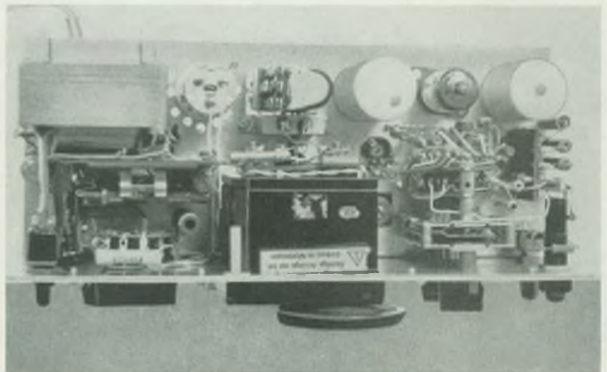
Bild 5: Ansicht des Chassis von hinten, in der hinteren Reihe sind von links nach rechts zu erkennen C4, C7, ECC 81, C8, Relais A, 150-V-Stabilisator (hier keine handelsübliche Ausführung), Netztransformator; dahinter Schalter S1 (hier „Fobana“-Mehrstellenschalter), Maßinstrument und Lötösenplatte für Netzteil
