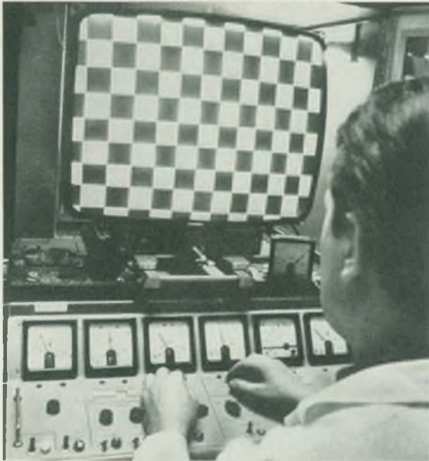
Die Vollrechteck-Bildwiedergaberöhre B 61 G 1 mit 110°-Ablenkung zeichnet sich durch eine brillante Bildwiedergabe aus. Die Röhre ist nach dem Selbend-Verfahren hergestellt und kann ohne Schutzscheibe eingebaut werden (VEB WF Berlin)
