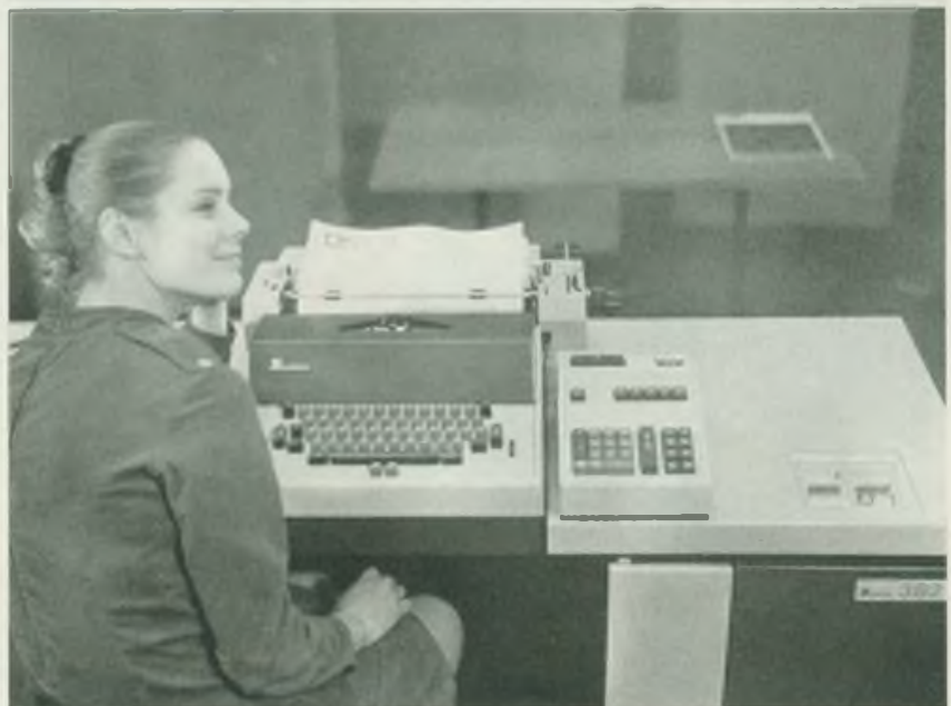
Der elektronische Abrechnungsautomat SOEMTRON 382 des VEB Kombinat ZENTRONIK ist das Grundmodell dieser Baureihe, deren weiteren Typen bereits zu den peripheren Geräten von Datenverarbeitungsanlagen zählen Fotos: Werkaufnahmen
