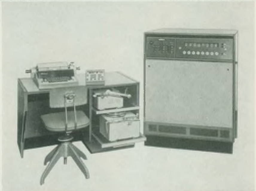
Die elektronische Rechanlage CELLATRON C 8205 ist ein hochleistungsfähiger, programmgesteuerter Digitalrechner für wissenschaftlich-technische und für ökonomische Aufgabenstellungen (VEB Kombinat ZENTRONIK)
