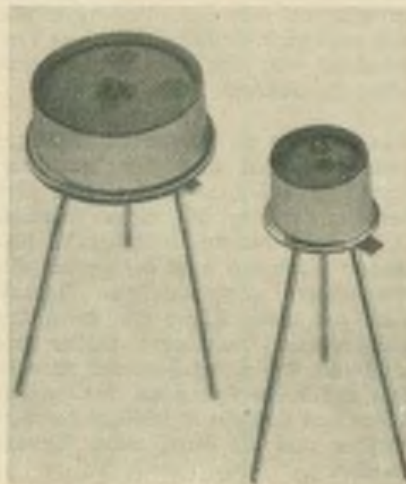
Bild 4: Zwei selbsthergestellte Fototransistoren (Foto: U. Zeitlmeier)
