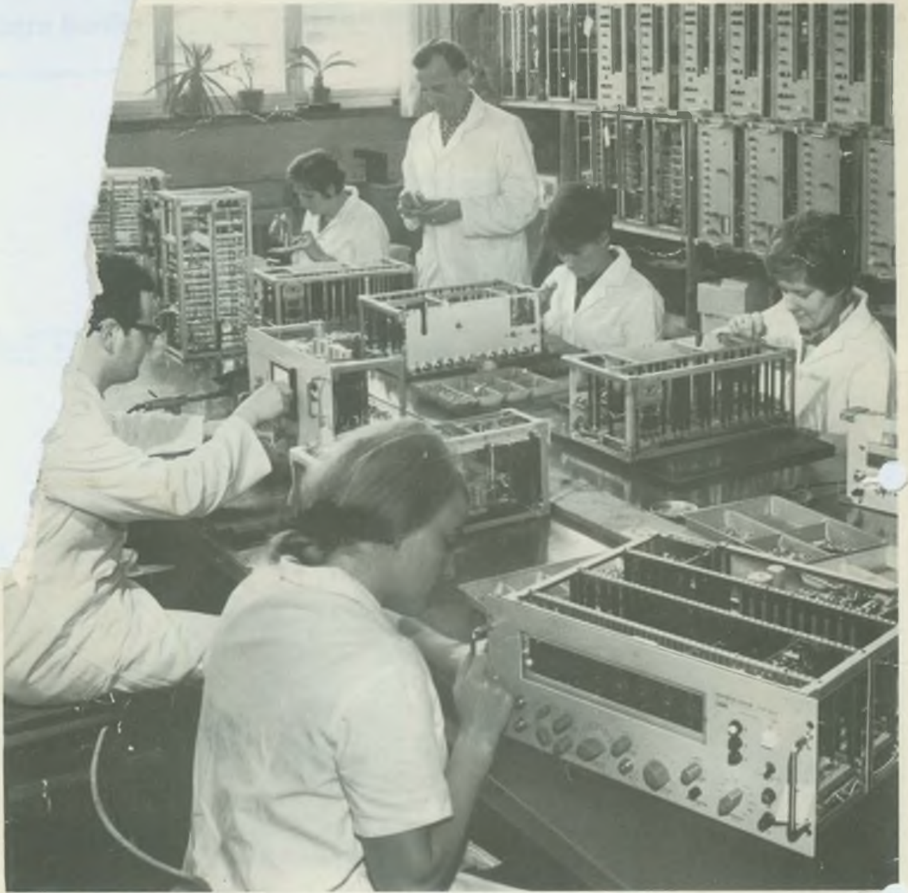
Montage von elektronischen Meßgeräten im Kombinat VEB Funkwerk Erfurt. Im Vordergrund ein Universalzähler „Typ 3515“, der einen Frequenzbereich von 10 Hz bis 50 MHz er- faßt. Damit eignet sich dieses Gerät auch als Frequenzmes- ser bis in den KW-Bereich Foto: RFT-Werbung
