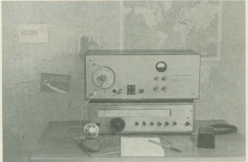
Bild 1: Stationsfoto der transistorisierten Sende-Empfangsstation DM 2 CEK, oben der Transistor-SSB-Sender, darunter der KW-Transistorempfänger für die KW-Amateurbänder
