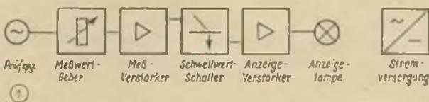
Bild 1: Übersichtsschaltplan des Diodenprüfgerätes
