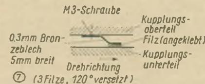
Bild 7: Die Konstruktion der Schwungmasse
