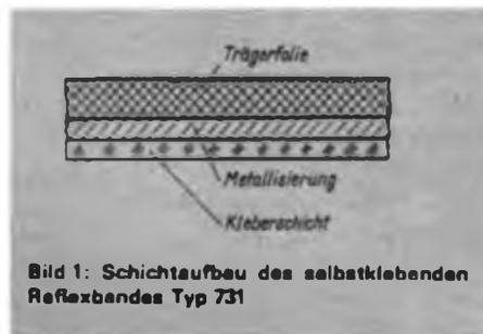
Bild 1: Schichtaufbau des selbstklebenden Reflexbandes Typ 731
