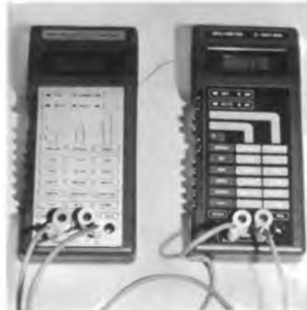
Die Digitalmultimeter G 1004 500 und B 1007 500 bieten hohen Komfort bei der Messung von Gleich- und Wechselspannungen und -strömen sowie von Widerständen. Sie enthalten als wesentliche Bauelemente C 7136, FAR 009 A, B 062 D und V 4030 D.
