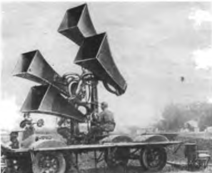
Sowjetisches Schallmeßgerät ST-2 zum Orten von Flugzeugen
