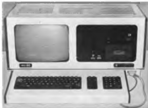
Der bekannte „MC 80“ ist ein 8-bit-Mikrorechner mit einer K 1520-Schnittstelle, Grafik-Option und integrierter Kassettenspeicher
