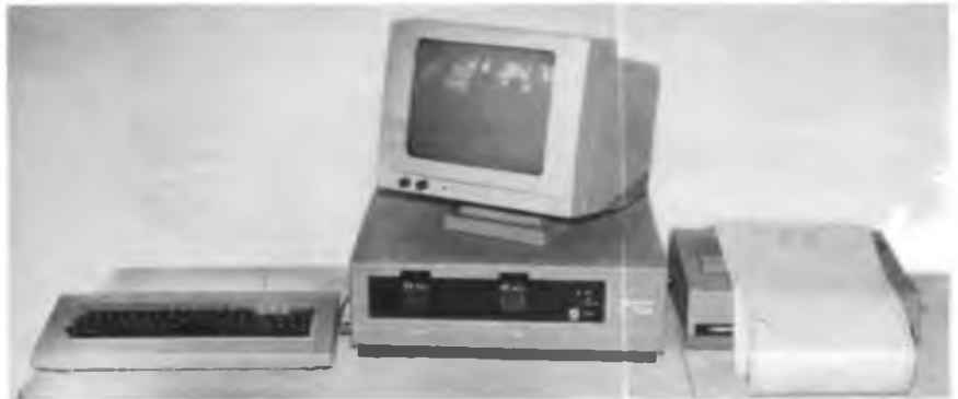
Der 16-bit-Arbeitsplatz-Computer A 7100 verfügt über 10 MByte Speicherkapazität. Einen besonderen Vorteil stellt seine Kompatibilität mit den Betriebssystemen
