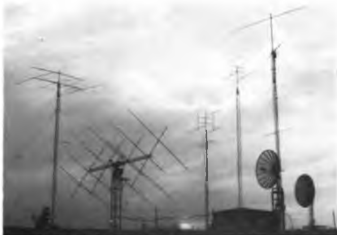
Die kooperativ betriebene HF/VHF/UHF/SHF-Anlage von WA0TKJ und WB0DRL erlaubt Betrieb auf 12 verschiedenen Amateurfunkbändern.
