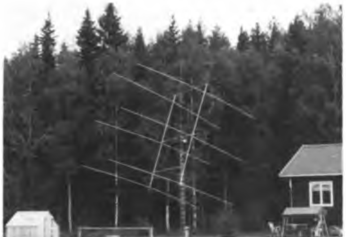
SM2CEW in Lulea mit etwa 22 dB d (6 x 16 Ele.) hat Y24QO mit seiner Anlage auch ohne Vorverstärker gehört. Peter vermittelt im europäischen VHF-net.
