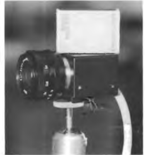
Miniatürisierte Fernsehkamera mit CCD-Bildaufnahmeelement (VEB Studioteknik Berlin)
