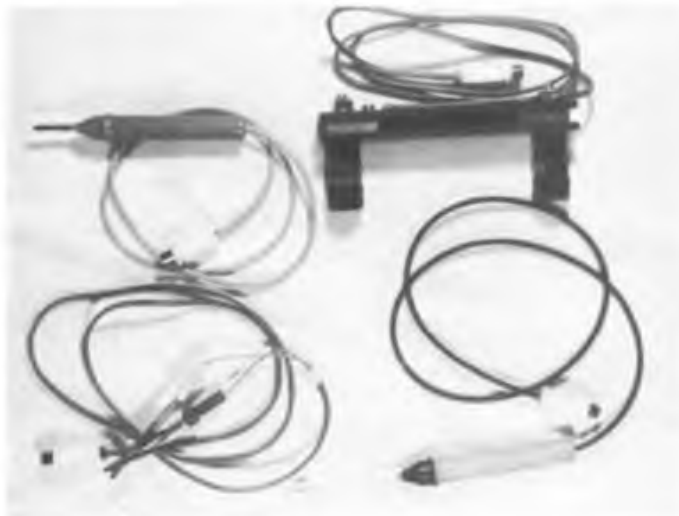
Bild 3: Meßkabel, Tastspitzen für 1000 V und ein Shunt für Strommessungen bis 10 A sind mit handelsüblichen VHF-Steckverbindungen aus der Rundfunk/Fernsehtechnik aufgebaut
