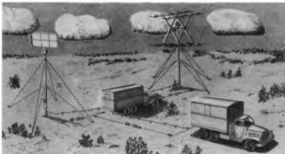
Die Funkmeßstation der Fernaufklärung P-8 in der Stellung (Schema/unten)
