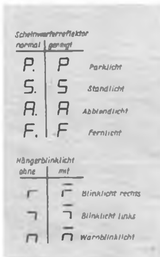
Bild 9: Darstellung der mit der Schaltung nach Bild 8 auf der VQE 24 erscheinenden Symbole
