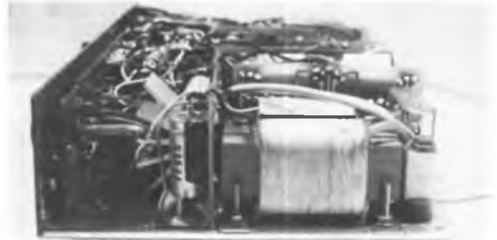
Bild 2: Blick auf die rechte Seite mit Netzteil und Netztransformator
