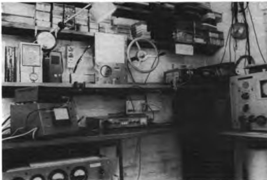
Bild 5: Mein Stationisch. In der Mitte der Transceiver mit aufgesetzter 10,7-MHz-Nachsetzer-Baugruppe (Bandbreite 110 Hz). Links daneben die mechanische Ablaufsteuerung mit dem Schatthel. Darüber ein Frequenzmesser, darunter die Leistungs-Endstufe. Neben dem
