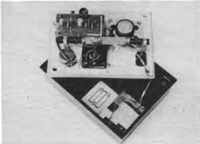
Bild 8: Blick auf das geöffnete Gehäuse des Spielzeug-Radios, erkennbar die Anordnung der Batterie-Stromversorgung
