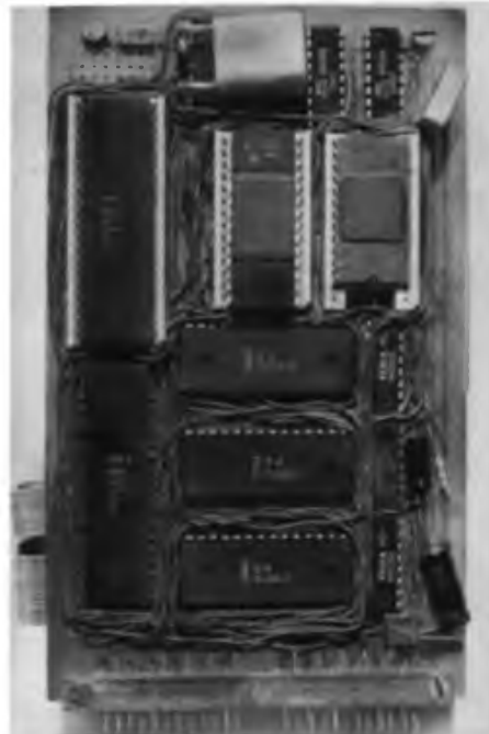
Bild 22: Die obere Leiterplatte des Mikrorechnermoduls mit aufgesteckten EPROMs
