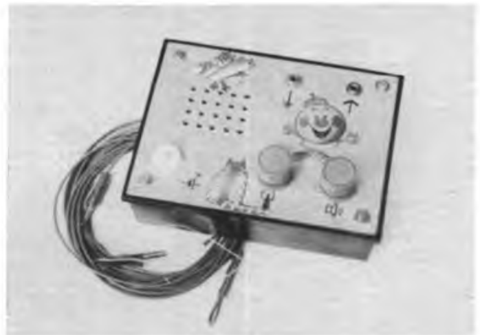
Bild 9: So sieht das fertiggestellte Spielzeug Radio aus, das in einen mittelgroßen Stapelkasten eingebaut wurde
