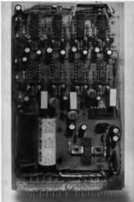
Bild 21: Die Leiterplatte des NF-Verstärkers und der Flip-Flop-Teilerketten
