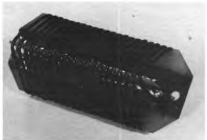
Bild 1: Die Abmessungen des Cevaunitstückes für einen Trap, darunter die der Einzelteile (Spulenkörper und Folienkondensator)
