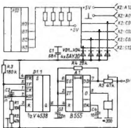
Bild 1: Stromlaufplan zur Bildung des Tastatursignals
