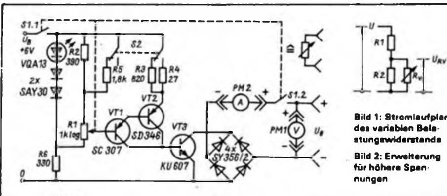
Bild 1: Stromlaufplan des variablen Belastungswiderstands
