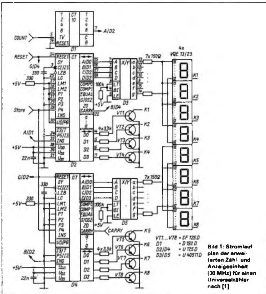
Bild 1: Stromlaufplan der erweiterten Zähl- und Anzeigeeinheit (30 MHz) für einen Universalzähler nach [1]
