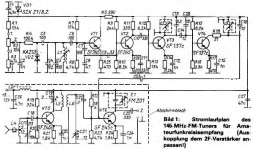
Bild 1: Stromlaufplan des 145-MHz-FM-Tuners für Amateurfunkrelaisempfang (Auskopplung dem ZF-Verstärker anpassen!)
