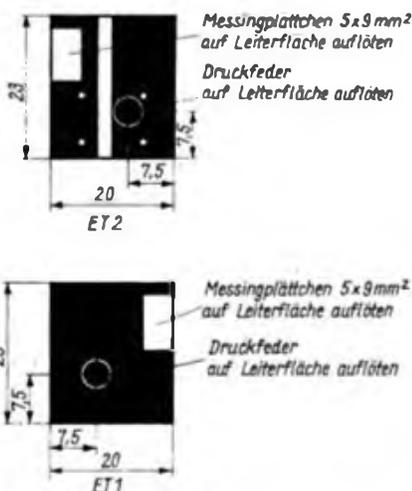
Bild 14: Batteriehalterung ET1 und ET2
