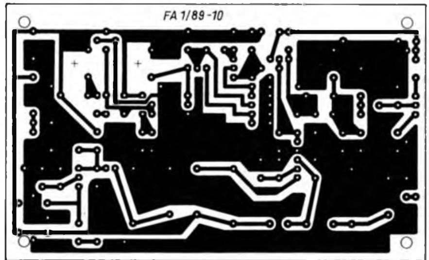
Bild 2: Leitungsführung der Platine für den 145-MHz-FM-Tuner
