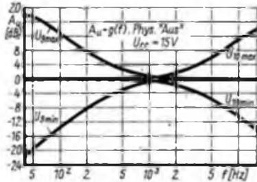
Bild 5: Klangeinstellkurve bei einfacher Tiefenbeschaltung
