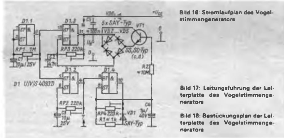
Bild 16: Stromlaufplan des Vogelstimmengenerators
