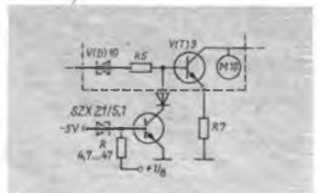
Spannung nicht größer als -4,3 V ist, wird der zusätzliche Transistor sicher gesperrt. Er beeinflusst die Funktion des Schaltnetzteils nicht. Erhöht sich die Spannung, so werden die Ansteuerung für den Transistor VT9 kurzgeschlossen und die Ausgangsspannung abgeschaltet. Bei der Ableitung der Spannung +U<sub>b</sub> ist darauf zu achten, daß sie bis zum völligen Abschalten des Netzteils anliegt.
