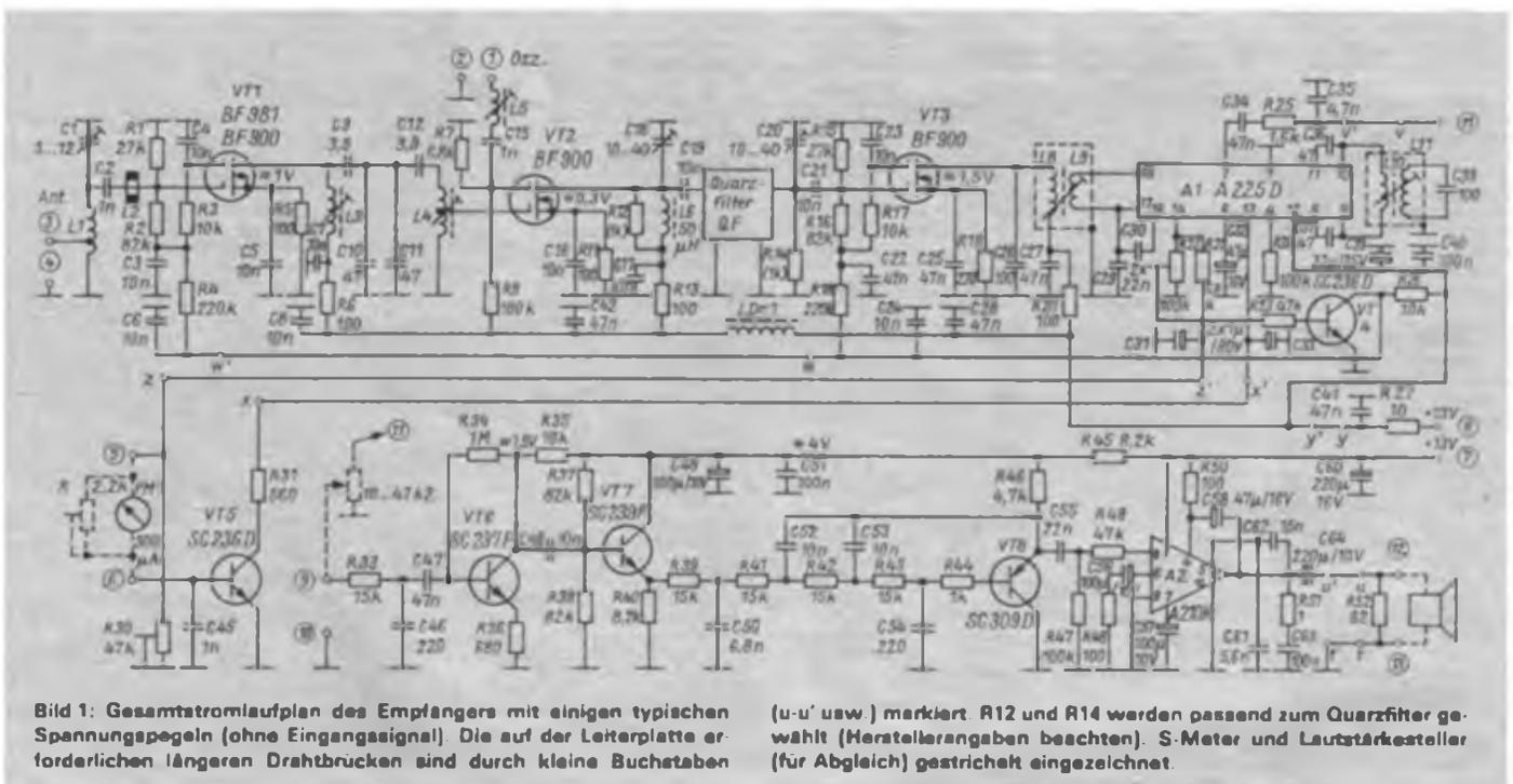
Bild 1: Gesamtstromlaufplan des Empfängers mit einigen typischen Spannungspegeln (ohne Eingangssignal). Die auf der Leiterplatte erforderlichen längeren Drahtbrücken sind durch kleine Buchstaben
