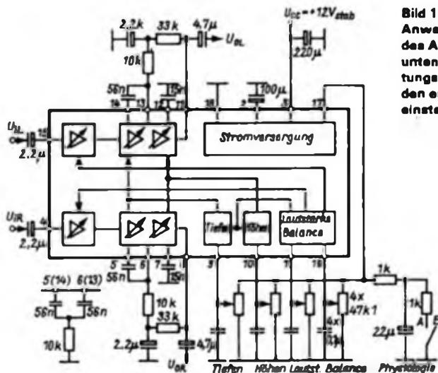
Bild 1: Meß- und Anwenderschaltung des A 1524 D. Links unten die Beschaltungsmöglichkeit für den erweiterten Tiefeneinstellbereich.
