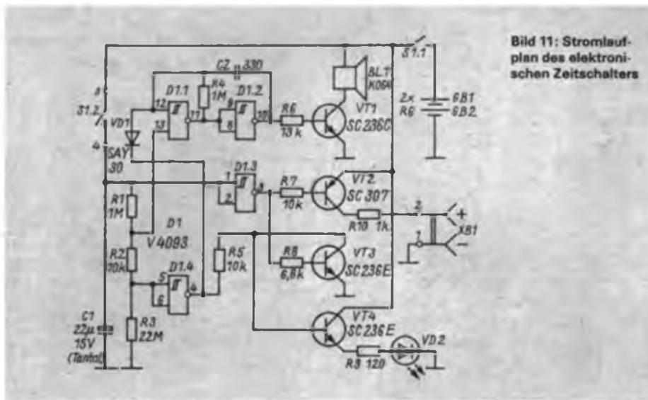
Bild 11: Stromlaufplan des elektronischen Zeitschalters
