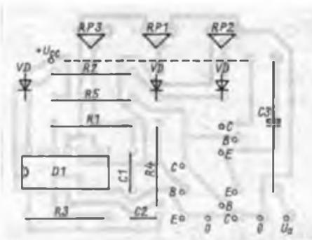
tor C2 ge- und entladen wird. Damit steht zur Beeinflussung eine dreieckförmige Spannung zur Verfügung. Ein effektvoller Klang ist durch drei Einstellmöglichkeiten gesichert. Bezüglich der Endstufe gilt das bereits Gesagte. Den entsprechenden Leiterplattenentwurf zeigen Bild 14 und 15.
