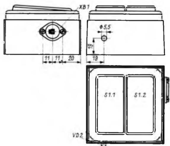
Bild 15: Gehäusedarstellung des Zeitschalters
