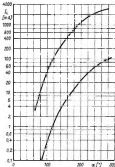
Bild 3: Strome durch den Belastungswiderstand nach Bild 1 in Abhängigkeit vom Stellwinkel  $\alpha$  des Potentiometers R1 bei etwa 5 V Gleichspannung
