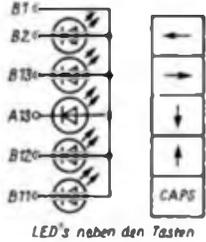
Bild 2: Tastenmatrix und Anschlußbelegung des Tastatursteckverbinders
