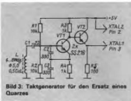
Bild 3: Taktgenerator für den Ersatz eines Quarzes
