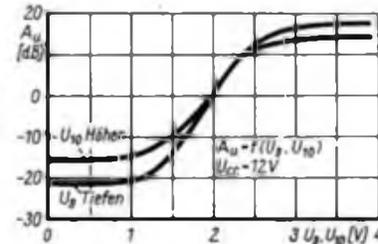
Bild 10: Einstellkurven für die Höhen- und Tiefenbeeinflussung
