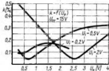
Bild 8: Abhängigkeit des Klirrfaktors von der Ausgangsspannung
