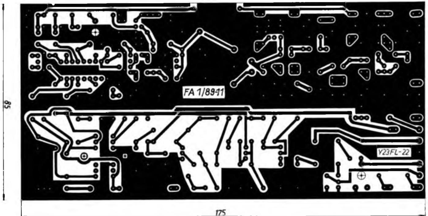
Bild 2: Leitungsführung der Platine für den Empfänger
