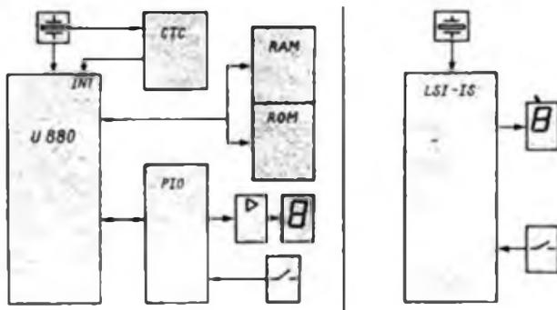
Bild 1: Vergleich des Aufwandes einer „konventionellen“ mikroprozessorgesteuerten Digitaluhr mit einer LSI-Uhr
