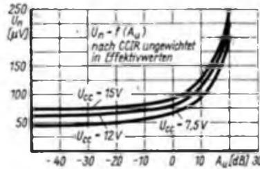
Bild 6: Ausgangsrauschspannung als Funktion der eingestellten Verstärkung
