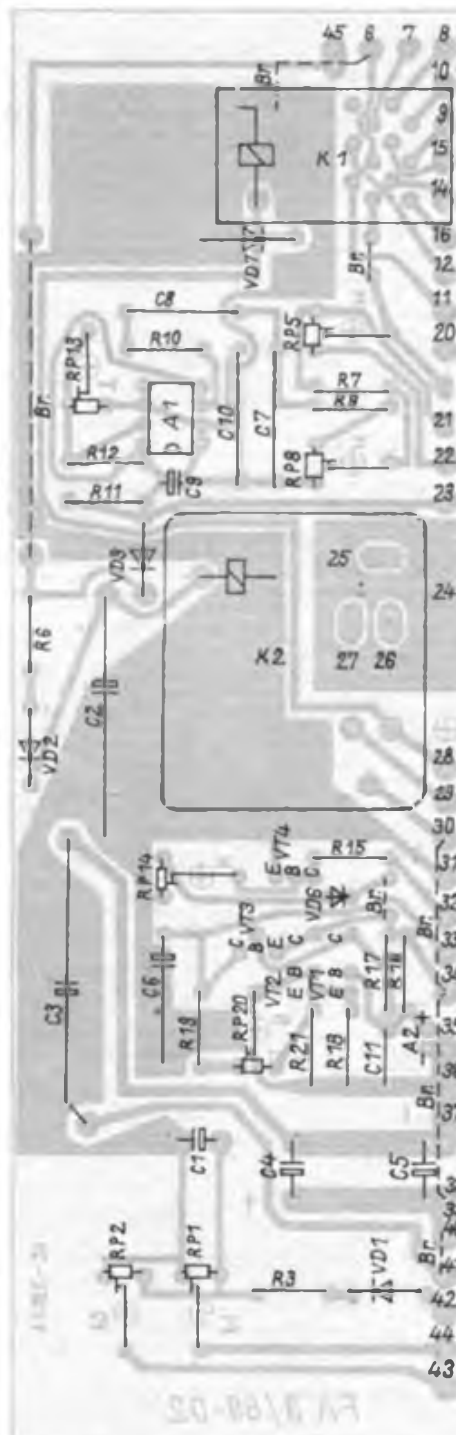
Bild 3: Bestückungsplan der Systemplatine und Bezeichnung der Anschlüsse
