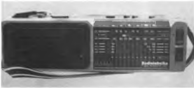
Der Taschenempfänger P5322 (UdSSR) empfängt den CCIR-UKW-Bereich, MW und LW sowie die Kurzwellenbereiche von 5,8 bis 12,6 MHz. Er fiel durch ein modernes Design auf.
