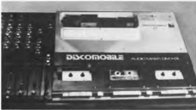
Die Disko-Anlage „im Koffer“ DM 1-01 (UdSSR) enthält drei Kassettenspieler und 8 Mixkanäle mit separater Klangregelung sowie ein Stereo-Endverstärkermodul.
