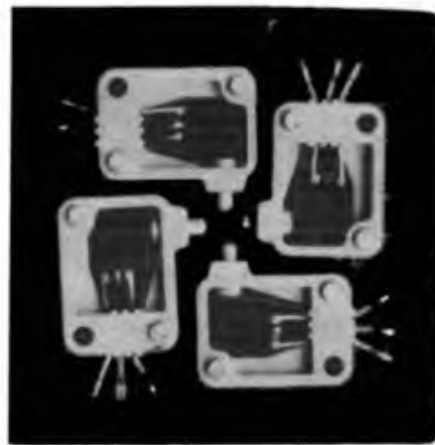
Bild 2: So werden auf der Pertinaxplatte die Mikrotaster angebracht
