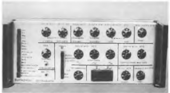
Die Volksrepublik Polen zeigte einen Percussionsynthesizer als Rackeinschub. Mit diesem Gerät ist eine Erzeugung von Percussionsklängen in großer Vielfalt möglich.
