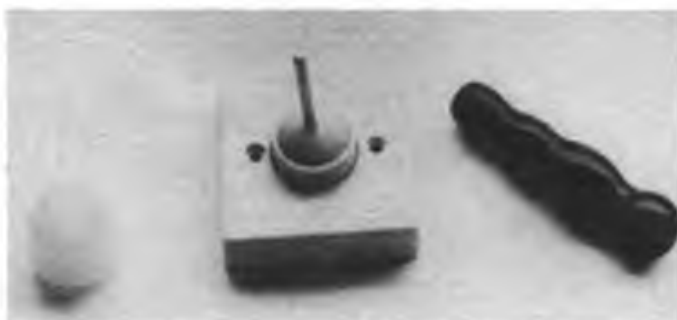
Bild 4: In der Bildmitte ist der fertige Joystick zu sehen. Links der Deo-Roller-Kopf, rechts ein Griff, der den Joystick noch handlicher macht.
