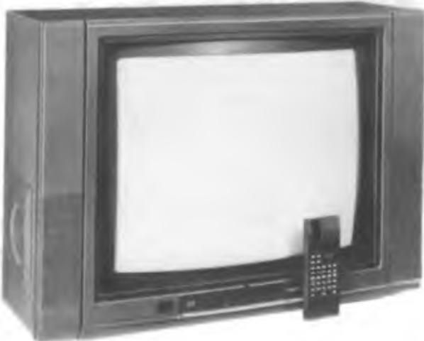
„Color 40“ heißt der erste Typ der vierten Farbfernsehgerätegeneration. Neben dem neuen Design der nun generell infrarotfernbedienten Geräte weisen diese völlig neue Schaltungskonzeptionen mit digitalen Abstimm- und Anzeigesystemen, umfangreichen optionalen Nachrüstungs- und Anschlußmöglichkeiten und eine verbesserte Farbwiedergabe auf.
