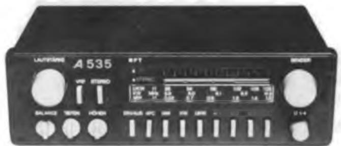
Der AM/FM-Stereoautoempfänger „A 535“ ist das Grundgerät einer neuen Gerätefamilie von Autoempfängern ohne Kassettenteil. Er empfängt im KW-, MW- und UKW-Bereich und besitzt neben vier Feastsender-tasten eine automatische Störunterdrückung. Die Senderanzeige erfolgt mit einer LED-Zeile, die innerhalb einer Fluoreszenzskala angeordnet ist. Ein sicherheitstechnisches Detail ist die Beleuchtung der Bedienelemente bei Dunkelheit.
