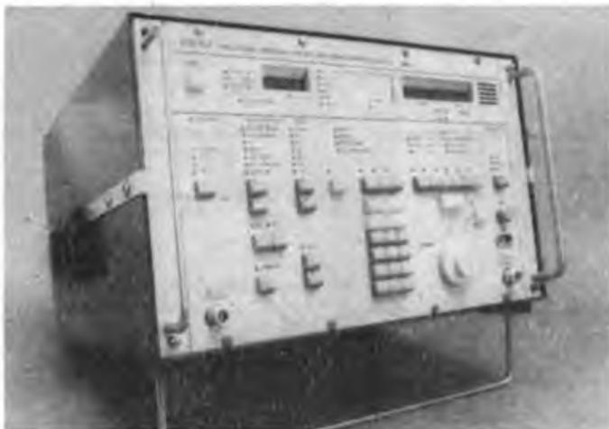
Der Meßplatz SMV 21 dient Funkstörungsmessungen und selektiven Messungen von Pegeln, Dämpfungen und Feldstärken im Bereich von 25 bis 1 000 MHz. Er enthält ein integriertes Rechnerauswertungssystem
