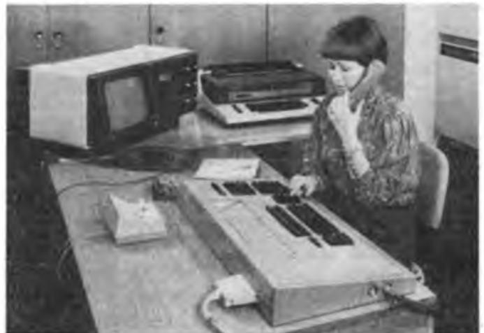
Die digitale Nebenstellenzentrale NZ 400 D/384 für 128 bis 384 Teilnehmerleitungen und max. 48 Hauptanschlußleitungen ist zur Digitalisierung von Betriebsnetzen vorgesehen. Mit zusätzlichen Einrichtungen wird sie zur Datenübertragungsstelle.
