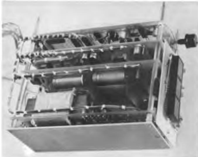
**Bild 20:** Ein Blick auf das fertige Modul vermittelt einen Eindruck von der mechanischen Konstruktion. Erkennbar auch die potentialgruppengetrennte Bündelverdrahtung
