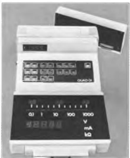
▲ Im Foto gut zu erkennen – der modulare Aufbau des Quad 01, hier die Grundausstattung mit Demonstrationsmodul, Grundgerät U-I-R,-Modul
