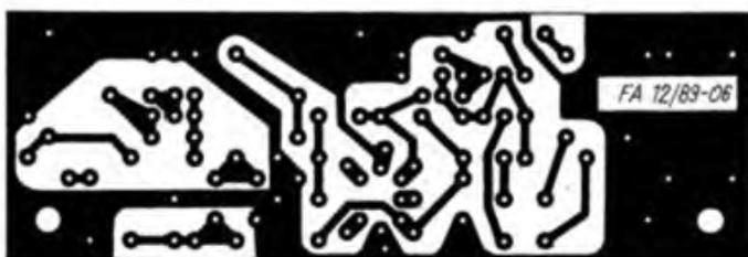
Bild 7: Leitungsführung der (doppelt kaschierten) Platine für die Oszillatorfrequenzauflösung
