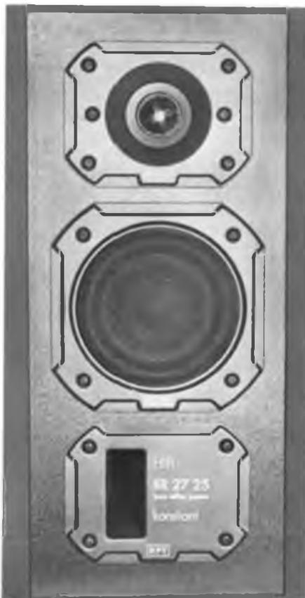
▲ Die 2-Wege-Baßreflexbox BR 2725 „konstant“ aus der neuen Boxenreihe des VEB Statron Fürstenwalde Sie entspricht den Forderungen an eine HiFi-Box nach TGL 28860/06 und ist durch eine Höchstbelastbarkeit von 50 VA bei einem Übertragungsbereich von 90 Hz bis 16 kHz gekennzeichnet. Die Box ist zur Komplettierung hochwertiger HiFi-Anlagen konzipiert.
