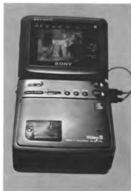
▲ Eine Spitzenleistung der Videotechnik stellte Sony unmittelbar nach der Ersträsentation auf der IFA '89 auf der LHM in Leipzig aus – den Video-Walkman GV 8, die Kombination eines 8-mm-Video recorders mit einem LCD-Farbfernsehgerät. Der kleine Bildschirm hat eine Auflösung von 92 000 Pixeln bei einer Diagonale von 3 Zoll. In Leipzig wurde diese Innovation mit einer Goldmedaille geehrt.
