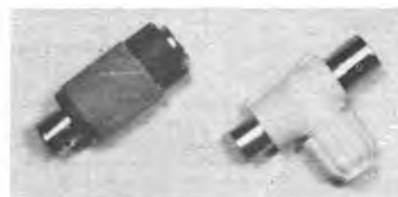
Bild 8: Übertrager auf verschiedenen Kernen aus der Bastelkiste, Ergebnisse siehe Tabelle
