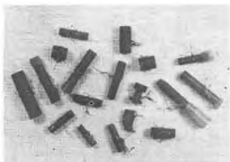
Bild 8: Übertrager auf verschiedenen Kernen aus der Bastelkiste, Ergebnisse siehe Tabelle
