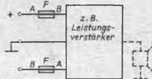
Bild 1: Anordnung der Sicherungsbaugruppe im Wechselstromkreis
