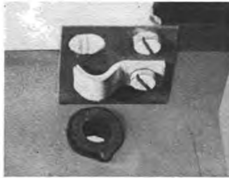
Bild 5 und 6: Beide Varianten des Netzkabel-Anschlusses: links die bereits ab Werk montierte Kaltgerätedose mit Schutzkontaktanschluß; rechts die abgerüstete Variante mit Kabeldurchführung, Klemmschelle und Schutzkontaktanschluß
