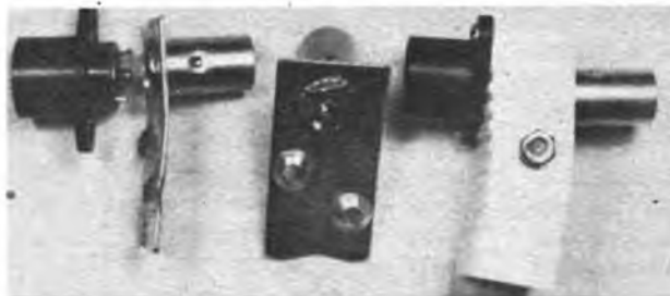
Bild 3: Entstehung des Kabeltrenners. Links sind deutlich die gekürzten Anschlüsse an Buchse und Stecker zu erkennen. In der Mitte der kurz auf den Stecker gelötete Übertrager. Rechts der komplette Zwischenstecker (Kabeltrenner).
