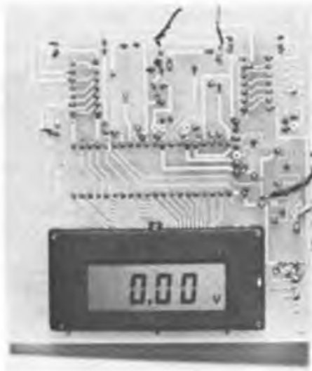
Bild 10: Ansicht des aufgebauten DVM-Moduls von der Leiterseite. Der Abdeckrahmen der Anzeige bietet eine gute Grundlage für eine ansprechende Frontplattengestaltung.
