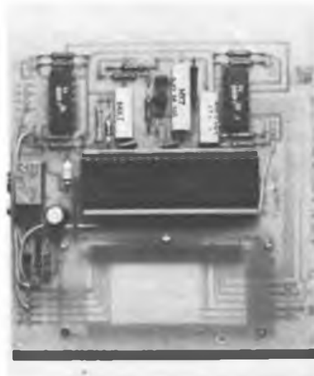
Bild 11: Ansicht der Baugruppe von der Bestückungsseite. Unterhalb des A/D-Wandlers ist noch Platz für Batterie und seitlich zu bedienende Tasten usw.
