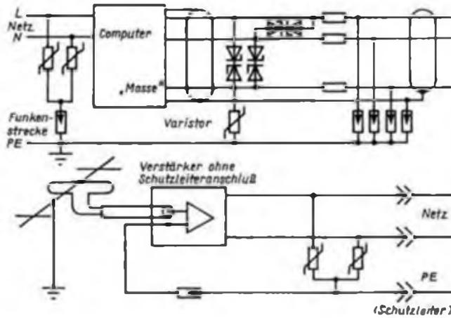
Bild 9: Schutzschaltung für einen Computer bei längeren Informationsleitungen [10]
