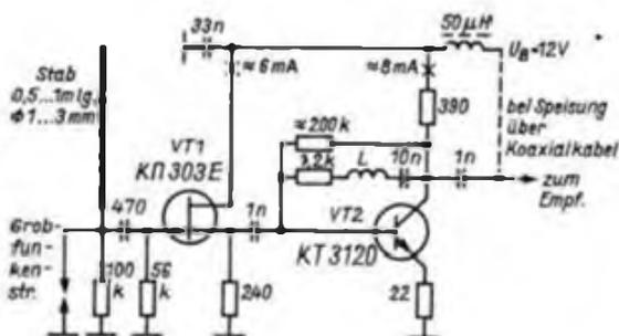
Bild 5: Stromlaufplan einer aktiven Antenne für 1,0 bis 30 MHz
