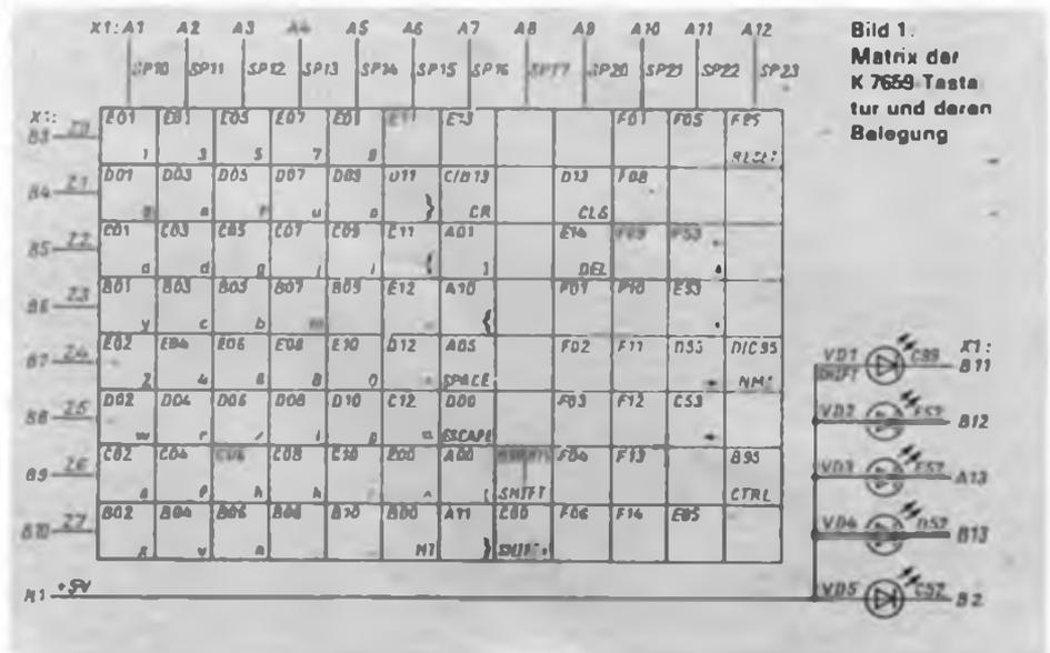
sprechend seiner Programmierung den Tastenkode an den Datenausgängen bereitstellt. Die Ausgänge D0 bis D6 werden unmittelbar mit dem Tastatursteckverbinder der zentralen Platine verbunden (X1 auf der zentralen Platine). Mittels D2, D3, D5, D6 und D14 erzeugen bei einer gedrückten Taste über VT2 und D10 das Statussignal TAST, das
