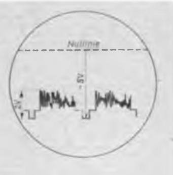
• Bild 1 Galvanische Trennung des BAS-Signals, die Wicklungen müssen gegeneinander auf 1,5 kV geprüft sein
