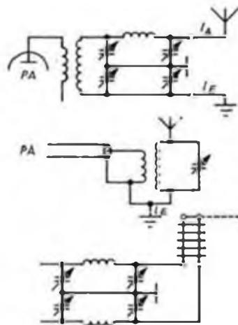
Bild 11: Prinzipstromlaufplan zur exakten Anpassung von Antenne und Gegengewicht. Ob angepaßt oder nicht, in jedem Fall ergibt sich auf der Erdleitung eine HF-Spannung (Höhe je nach Sendeleistung).
