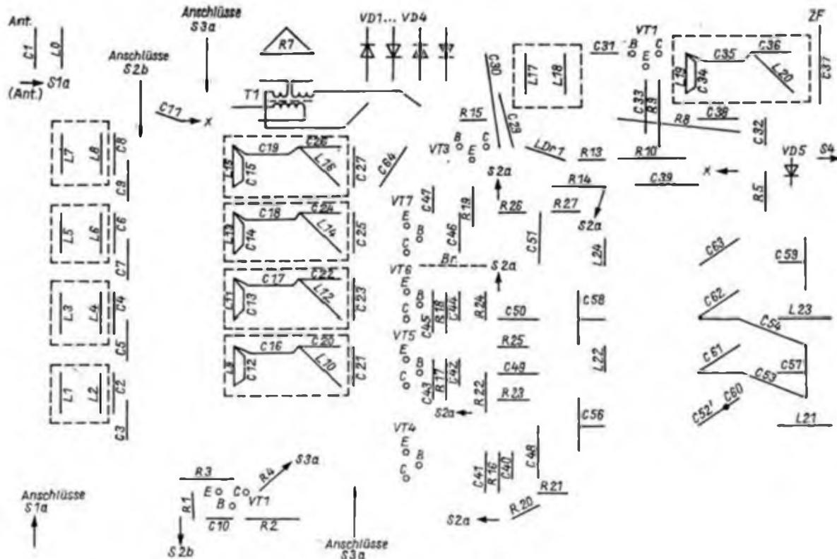
Bild 4: Bestückungsplan der Leiterplatte des Vierbandkonverters
