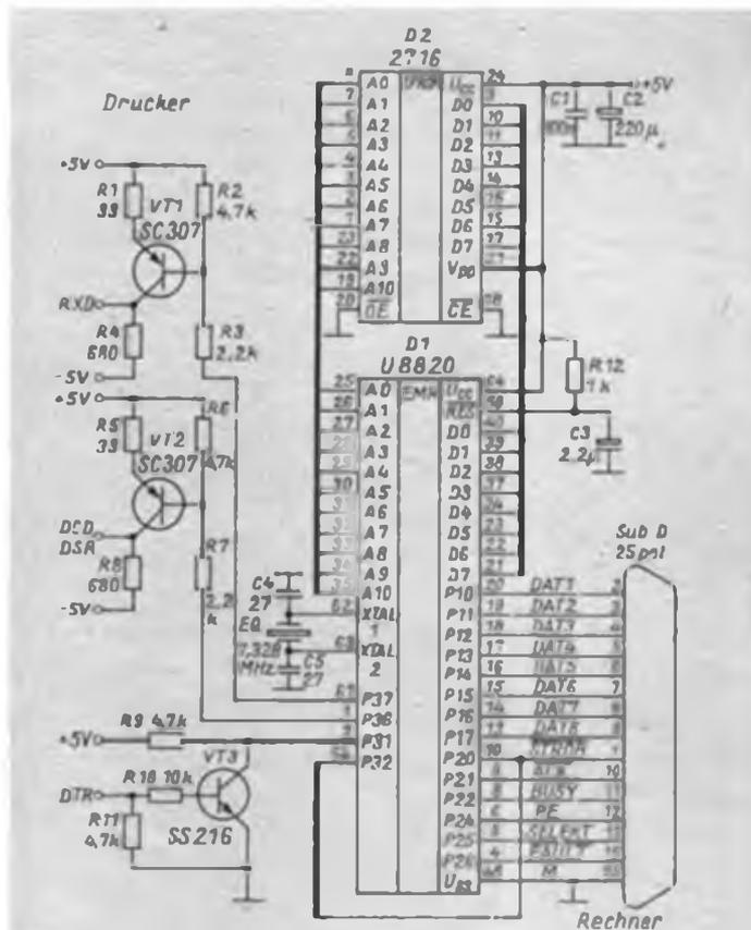
Bild 1: Stromlaufplan des Schnittstellenwandlers
