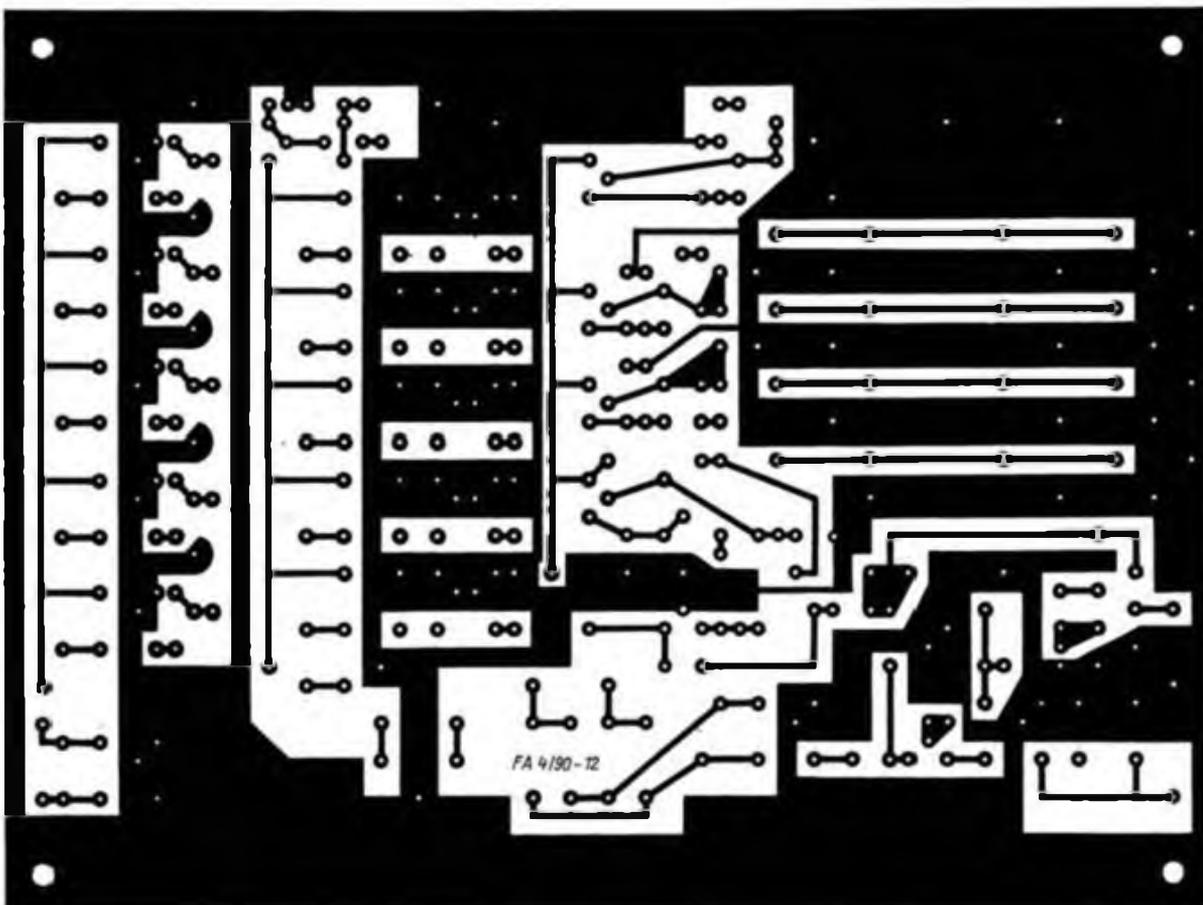
Bild 3: Leitungsführung der Platine für den Vierband-KW-Konverter
