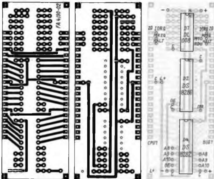
Bild 5: Leiterseite der Leiterplatte für D2, D4 und D7
