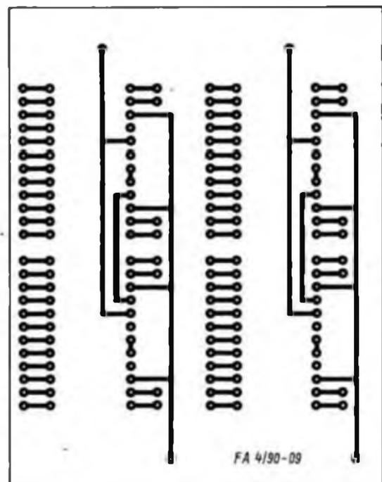
Bild 2: Layout der Leiterseite der Ansteuerplatine
