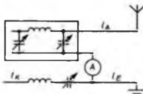
Bild 14: Wirkung der „künstlichen Erde“. Mit dem Reihenschwingkreis wird  $I_k$  so verlängert, daß am Gehäuse ein „Strombauch“ auftritt. Je nach Länge von  $I_k$  würde sonst am Gerät eine gefährliche HF-Spannung auftreten (u. U. „Spannungsbau“). Für die HF-Abstrahlung ist im Extremfall neben  $I_k$  maßgebend.
