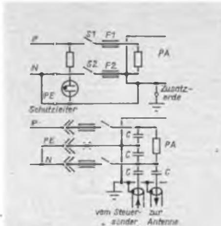
Bild 15: Netzeingang der Endstufe von Y26GM. Schalter S2 und Sicherung F2 sind durch den Schutzleiter überbrückt.
