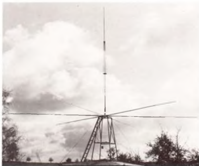
Bild 3: Die betriebsfertige Groundplane-Antenne am erhöhten Standpunkt. Diese Konstruktion hat den Vorteil, daß sie horizontale Radials ohne äußere Abspannpunkte erlaubt. Die „Rouse“ besteht aus Glasfiberstäben und soll lediglich die mechanische Stabilität des Strahlers erhöhen.
