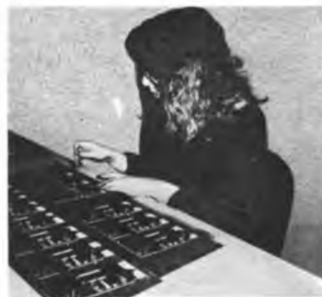
Geschickte Frauenhände sind beim Leiterplattenbestücken gefragt, das aufgrund der relativ kleinen Serien und des permanenten Sortimentswechsels manuell erfolgt
