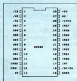
Bild 5: Anschlußbelegung des Interrupt-Controllers 8259
