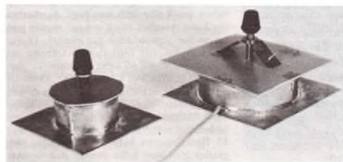
Bild 5: Ansicht zweier aufgebauter Frequenzmesser mit Hohlraumresonator
