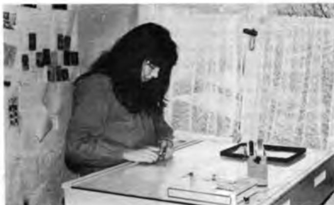
Akribische Puzzlearbeit im DARC-Verlag. Aus den „endlos“ gesetzten Spaltenfilmen und den reproduzierten Bildvorlagen entsteht im Klebeverfahren eine Seite der cq-DL.
